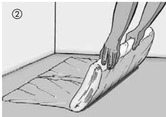
En règle générale, il faut toujours poser un film en polyéthylène de 0,2 mm d'épaisseur sur toutes les chapes et lors d'une pose sur un chauffage au sol. Les raccords des couches de film doivent se chevaucher sur environ 30 cm. Relever le film sur le mur et le couper après le montage des plinthes sur l'arête supérieure de ces dernières. **Comme le sol en liège HARO dispose d'ores et déjà d'une sous-couche en liège intégrée, il ne faut pas poser une sous-couche acoustique supplémentaire.**
