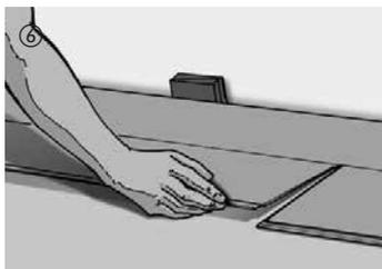
La deuxième rangée peut être commencée avec le reste de la première rangée (décalage des joints en bout d'élément d'au moins 40 cm). Ainsi on évite trop de chutes. Poser les autres lames les unes après les autres. Pour ce faire, les lames sont d'abord emboîtées sur la longueur sous l'effet d'une légère pression exercée dans la liaison.
